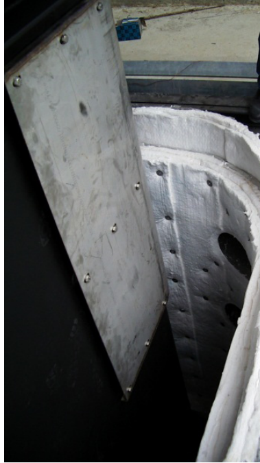
Moderne Faserisolierung der Ofenwand (Innenansicht)
