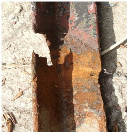
Unverzinkte Gittermastteile nach 30 - 40 Jahren
